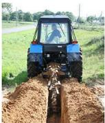
Предлагаю в аренду баровую установку, ЭТЦ (экскаватор траншейный цепной), ЭЦУ (экскаватор цепной универсальный), грунторез. Копка траншей под кабель, газ, зимний водопровод. Глубина до 2 м. Ширина от 21 до 40 см.
